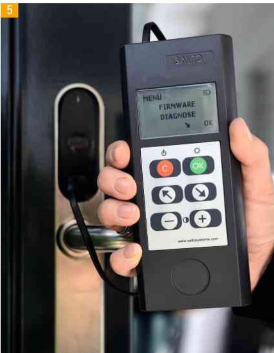
Offline-Schlösser werden mittels Programmiergerät mit neuen Einstellungen versorgt.
